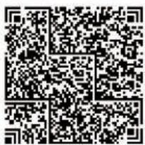
汉信码是一种矩阵式二维条码,具有知识产权免费、汉字编码能力强、抗污损、抗畸变、信息容量大等特点,是一种十分适合在中国广泛应用的二维条码,具有广阔的市场前景。汉信码是中国物品编码中心完成的国家“十五”重大科技专项—《二维条码新码制开发与关键技术标准研究》的成果,目前,免费的汉信码生成和识读工具已经成功上线。
