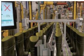
比利时工作靴制造商 Bekina Boots 利用 RFID 技术,提供有关其制造的每只靴子的在制品(WIP)和库存数据,以及最终客户穿着靴子在工业环境中使用的自动识别信息。该系统提供了聚氨酯安全鞋从生产到装运的唯一标识和可追溯性。
