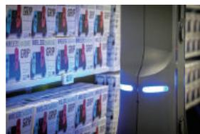
科技公司 Powercast 与零售自动化解决方案提供商 Badger Technologies 合作,提供基于机器人的电子价签 (ESL) 管理解决方案,可通过内置在机器人中的 RFID 阅读器更新产品价格标签。
